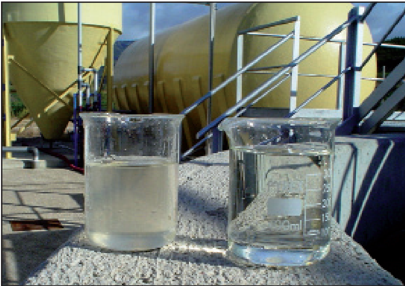
Figura 8. Muestra de agua tratada en la línea convencional (izquierda) y con MBR (derecha).
